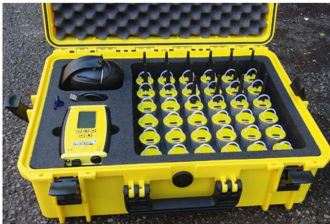
Enigma donnent des résultats très fiables, absolument nécessaires pour déterminer l'endroit exact de la fuite, de manière à éviter les travaux d'excavation inutiles. Lorsqu'il s'agit de conduites en plastique, localiser une fuite est encore plus difficile parce que le matériau atténue le bruit. Dans ce cas, Farys utilise le système Enigma hyQ. Ce procédé fonctionne avec un hydrophone, une sorte de microphone placé dans l'eau, qui
